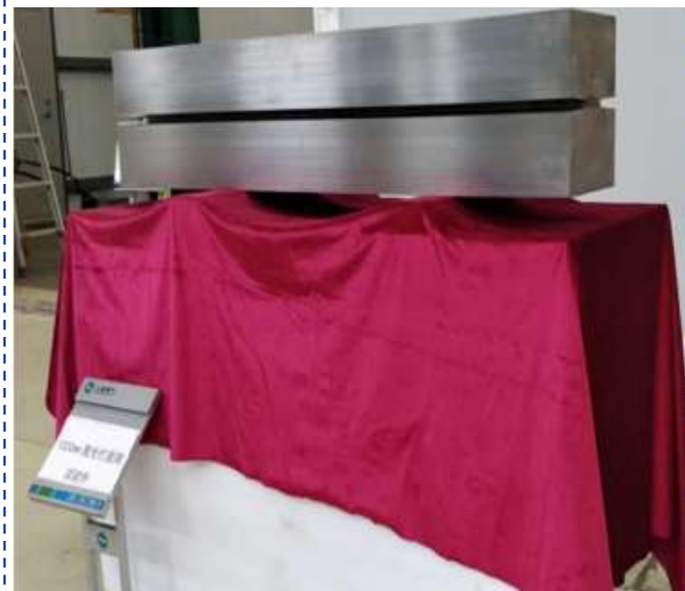
280mm厚热聚变线圈盒 80mm打底焊接
