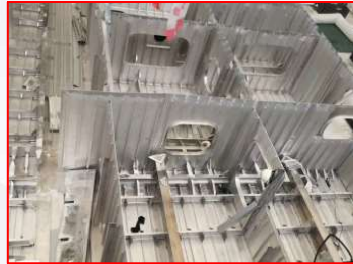
大气浮箱焊接结构
